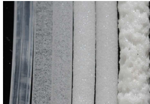
Fig 2: POE + endotherm blaasmiddel agent (0 tot 5% in stappen van 1%)
