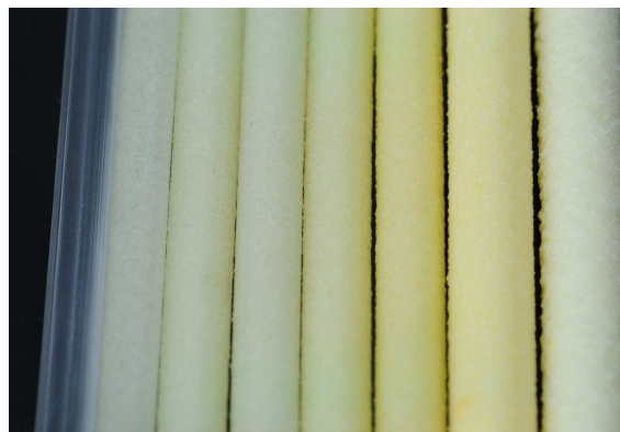
Fig 1: 1-6: POE + microsferen (0 to 5% in stappen van 1%), 7-8: POE + 5% exotherm blaasmiddel/microsferen (verschillende ratios).
