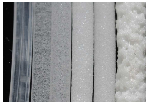
Fig 2: POE + agent moussant endothermique (de 0 à 5%)
