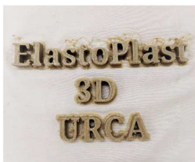
Fig 4: IstroFlex imprimé sur textile
